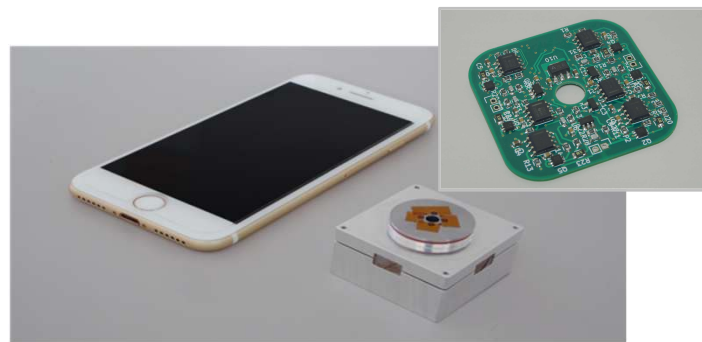
制御基盤を内包した小型インテリジェントサーボアクチュエータ
