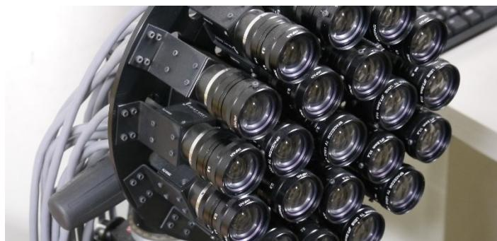
多視点カメラシステムを用いた新しい映像生成
