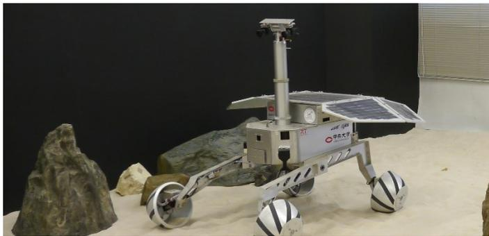
月惑星探査ロボットの周囲環境計測と遠隔制御
