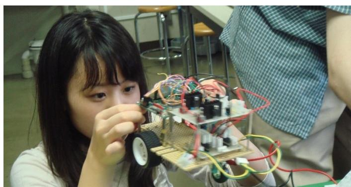
学生実験でライントレースロボットを作製する様子
