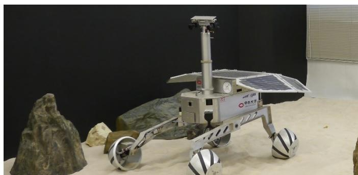
月惑星探査ロボットの周囲環境計測と遠隔制御
