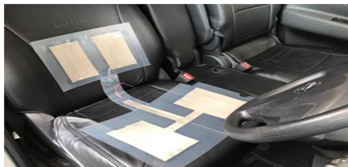
非接触心電計測に基づく車載用眠気予測システムの開発
