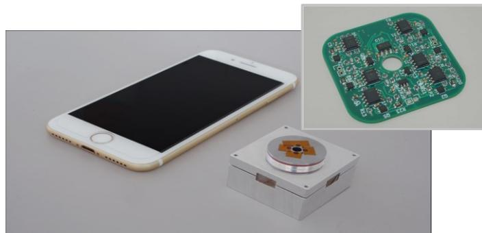
制御基盤を内包した小型インテリジェントサーボアクチュエータ
